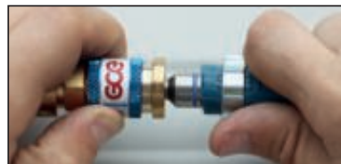
2. Ziehen Sie die blaue Hülse der Schnellkupplung zurück und führen dann den Kupplungsstift fest ein.
